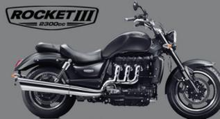
Foi constatada a necessidade de substituição do módulo de controle eletrônico do motor nos modelos acima listados, devido a uma ativação inadequada dos injetores de combustíveis pelo módulo eletrônico do motor (ECM), fazendo com que os injetores apresentem falha de funcionamento, causando perda de potência ou, excepcionalmente, o desligamento do motor, podendo ocasionar a parada da motocicleta.
